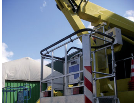
Bild 6-4: Absicherung von Bedienpult und Geländer durch eine Abschaltleiste gegen Quetschgefahren
