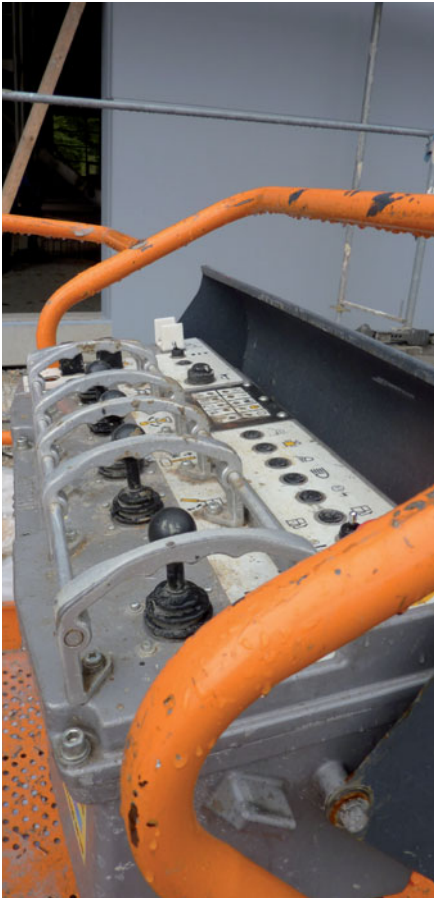
Bild 6-3: Schutzbügel gegen unbeabsichtigtes Betätigen der Bedienelemente
