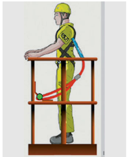
Bild 9-3: Einsatz von PSA gegen Absturz beim Verfahren
